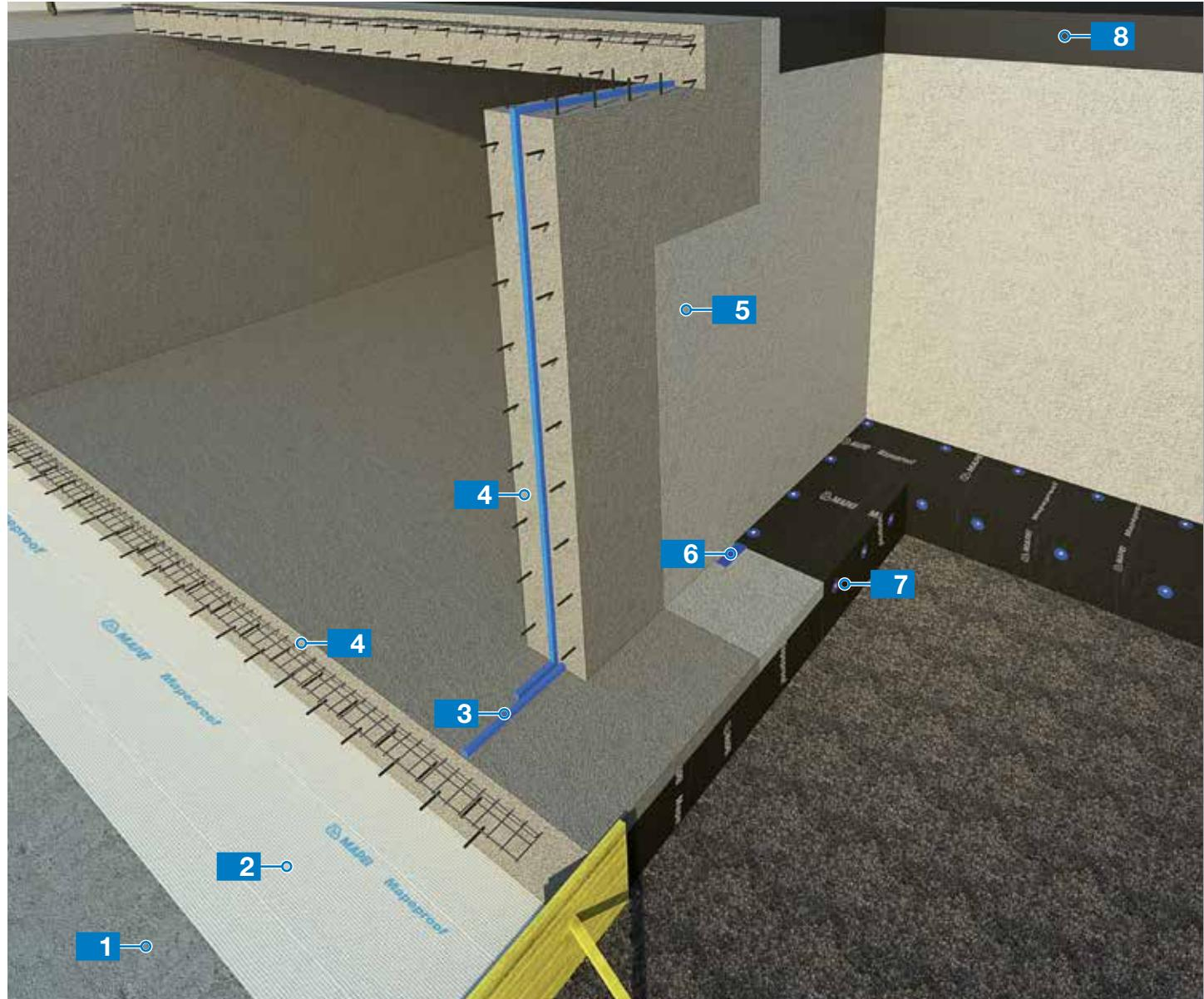
Гидроизоляция новых железобетонных конструкций на уровне грунтовых вод при выемке грунта экскаватором
