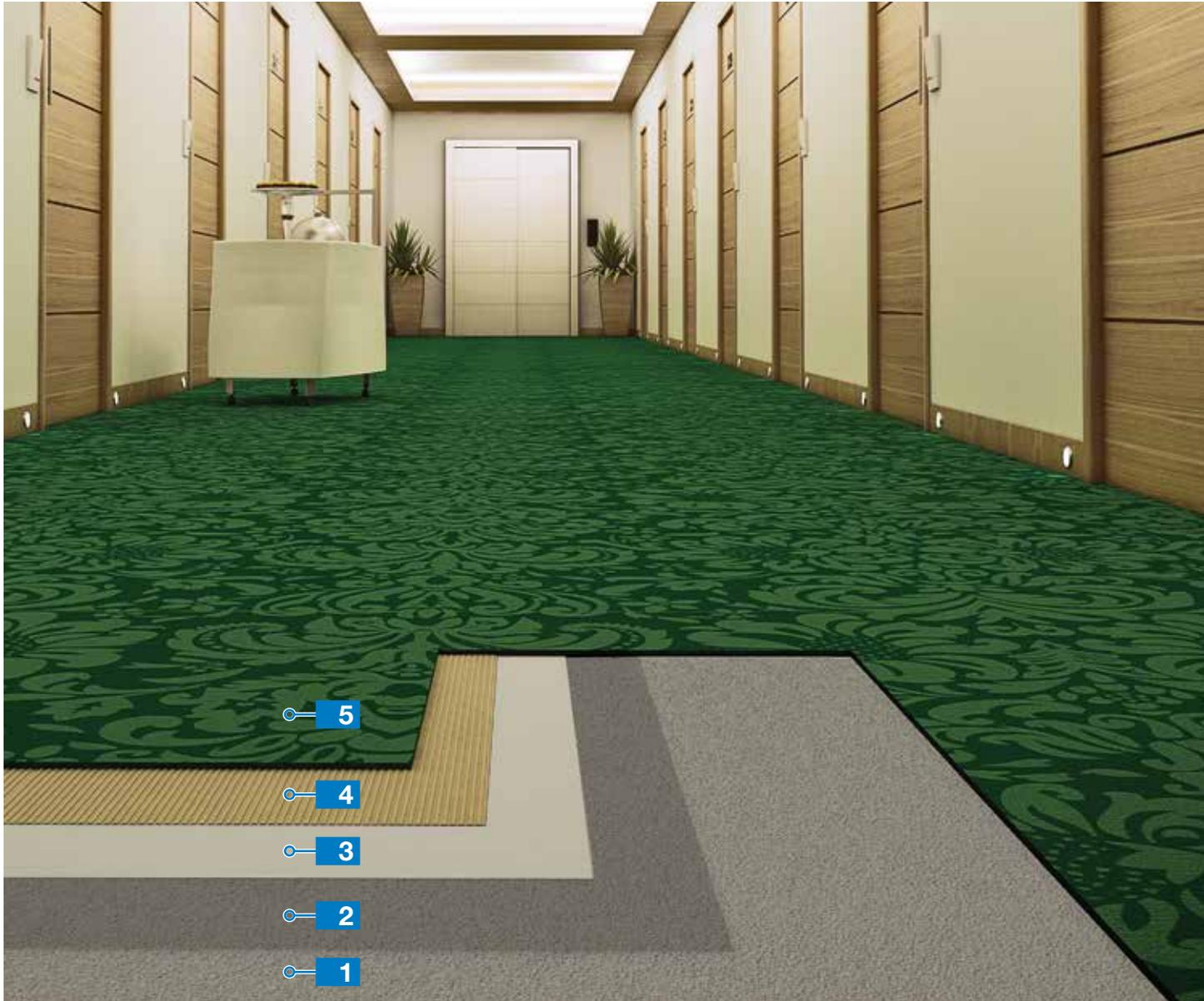
Система для укладки текстильных и иглопробивных напольных покрытий на ангидритные стяжки
